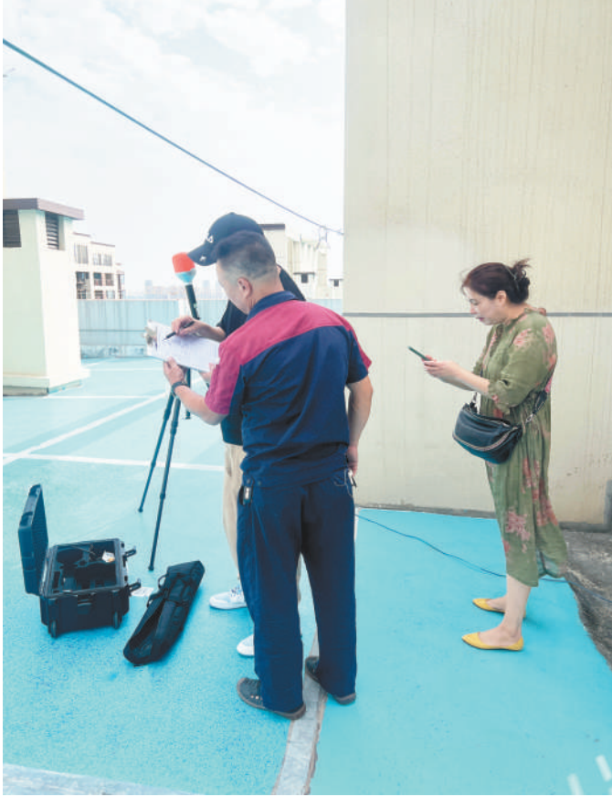
图为工作人员开展通信基站环境监测。
