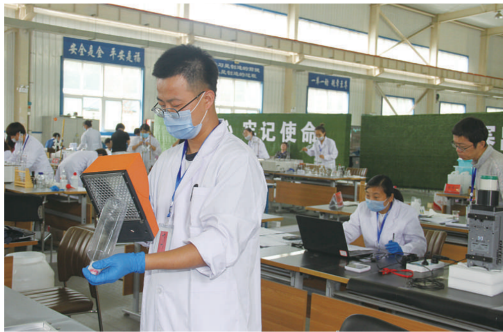
图为辐射环境监测技术人员正在对样品表面α、β污染水平进行检测。 崔万杰供图
