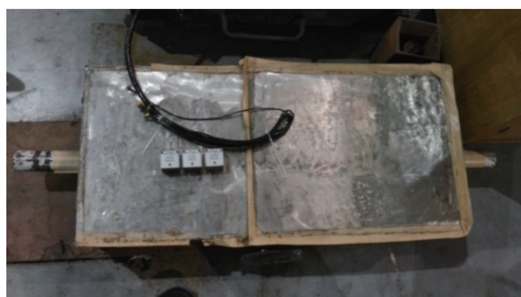
图3 超声检测显示性质判定的验证试块和探头
