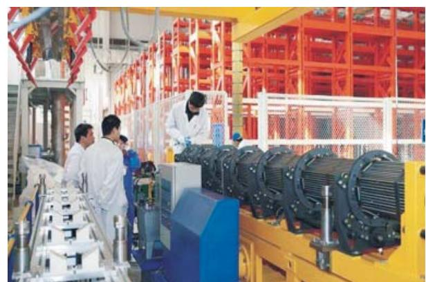
图29 核燃料元件生产线
