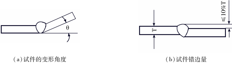
图 1 板状试件的变形角度和错边量
