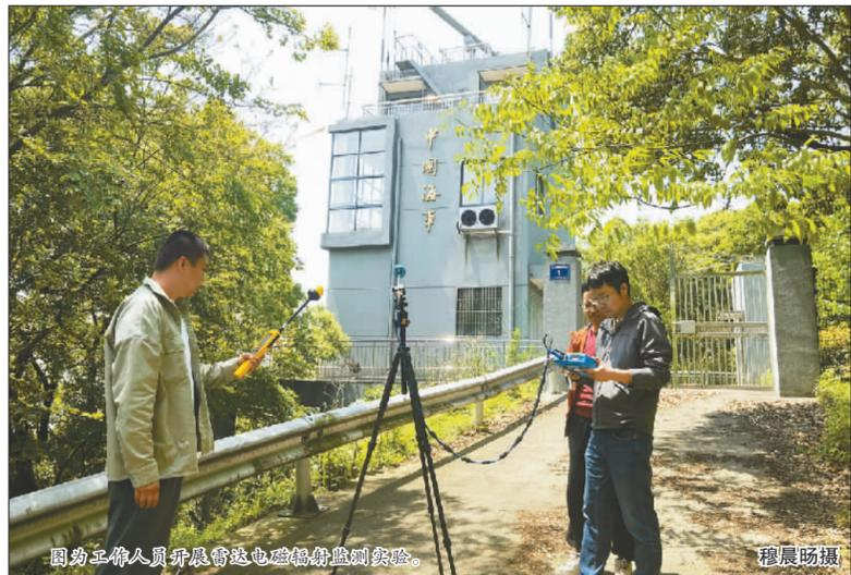
图为工作人员开展电磁辐射监测实验。
