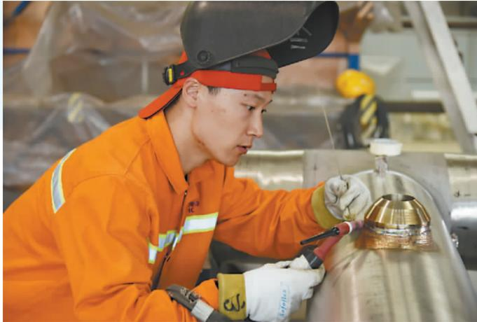
图为豆存印正在检查核级管道管座部位焊缝。 国核设备供图
