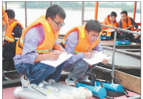
图为参训人员在进行γ辐射剂量率现场测量仪器比对。高德年摄
