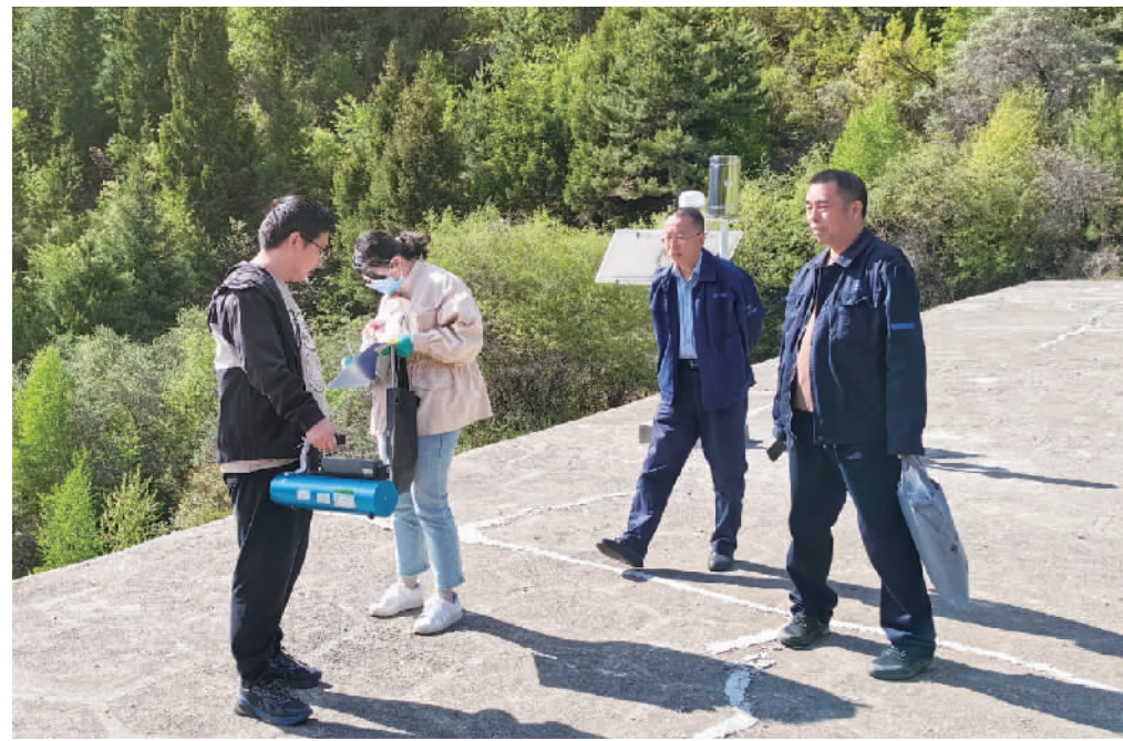
图为监测人员正在测量尾矿库坝体γ剂量率。
