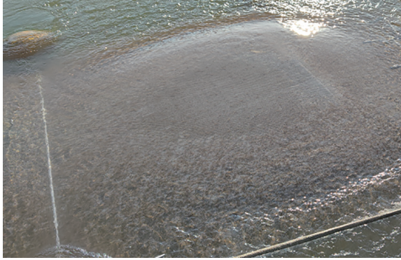
图4 全2 mm网兜堵塞情况 Fig.4 Blockage of the full 2 mm net bag
