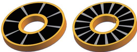
图1 止推盘与推力盘结构
