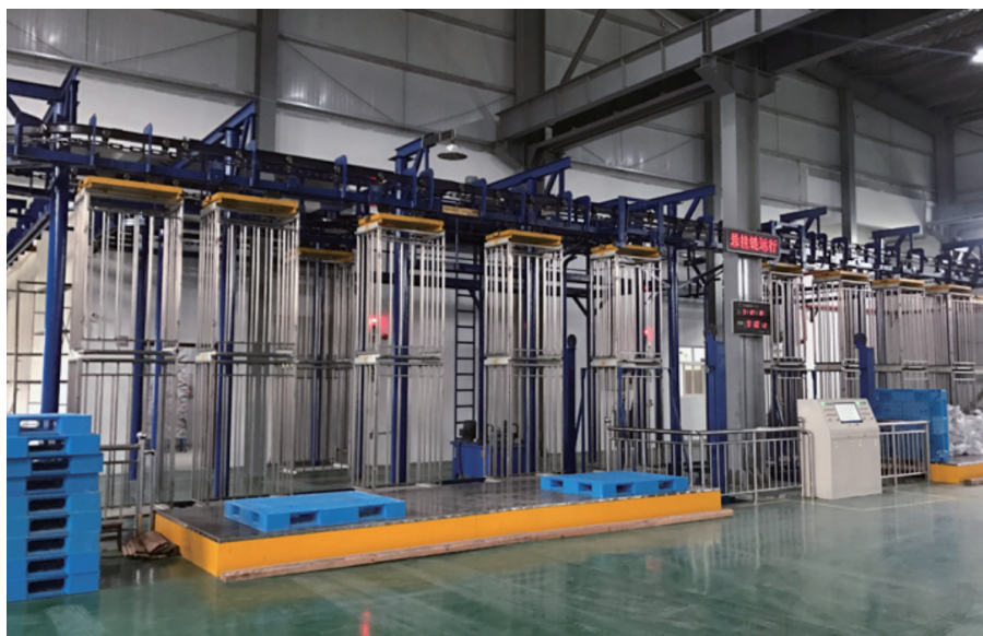
图2 咸阳华科辐照技术有限公司的悬挂式箱笼吊具
