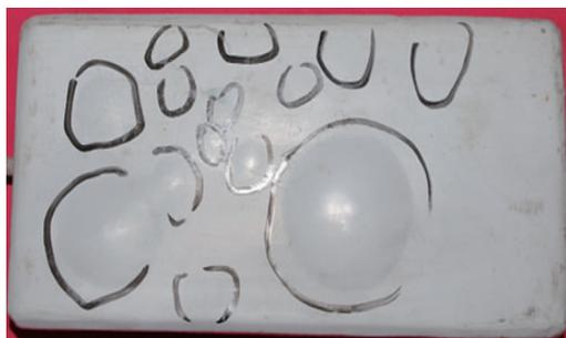
图 6 服役 15 年的安全壳内混凝土涂层留样 LOCA 测试最大缺陷面
